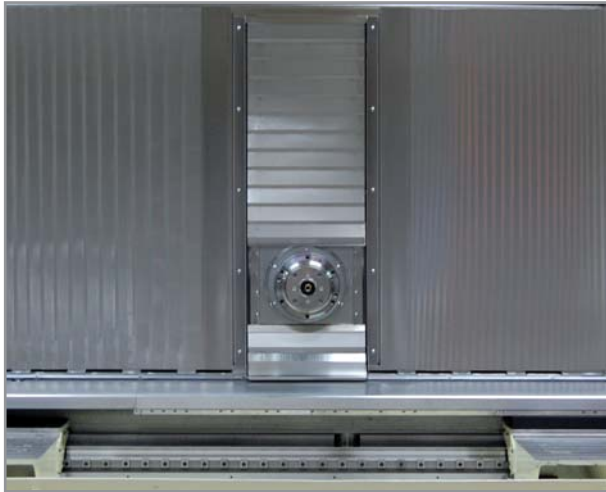
Einsatz von Lamellen Faltenbälgen in der Praxis
