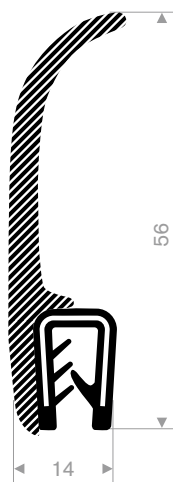
245.00.876 pvc + mosrubber klembereik 1-3 mm rollengte 25 meter
