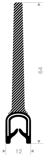
245.00.890 pvc + volrubber klembereik 1,5-4 mm rollengte 40 meter
